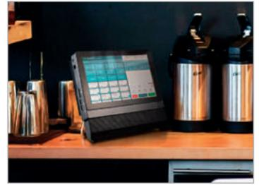
solo es claramente menor en tamaño y dispone de una pantalla capacitiva multitáctil, sino que también viene con funciones muy convincentes en la práctica. Se han optimizado el cableado y la posición de funcionamiento, los dispositivos USB 4G operan con alto reconocimiento de señal con antenas externas y, por supuesto, cuenta con gran número de puertos de entrada/salida en caso necesario. La WLAN, la cámara web, el altavoz y el micrófono también forman parte del equipo.
